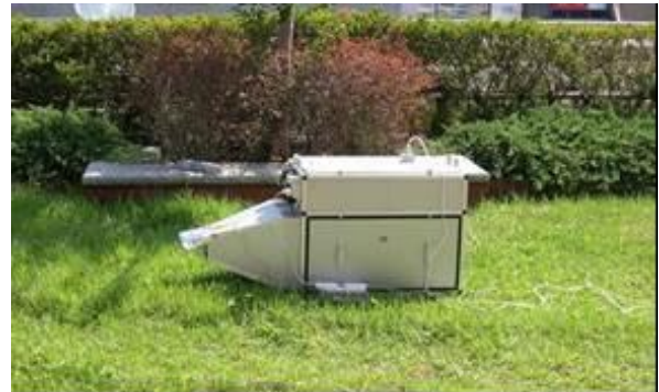
写真 5 簡易蒸発散測定装置の設置状況
