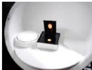
図 8 d. 上方反射の試料反射光量測定
