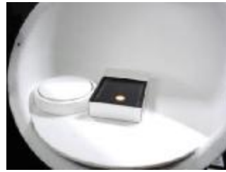
図 8 b. 半球反射の試料反射光量測定
