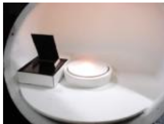
図 8 c. 上方反射の基準光量測定
