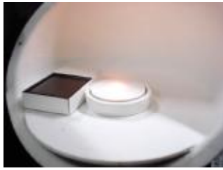
図 8 a. 半球反射の基準光量測定
